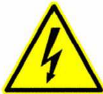
Tensione elettrica pericolosa
